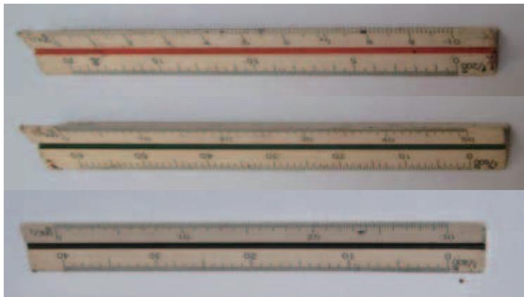
圖4.22 三角形斷面比例尺
