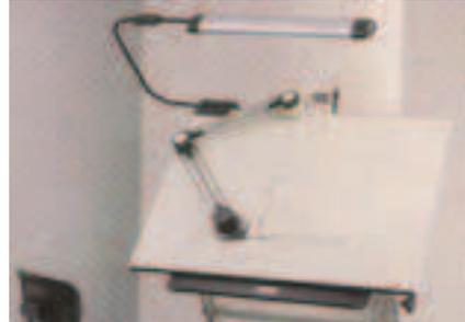
圖4.29 手臂式製圖機
