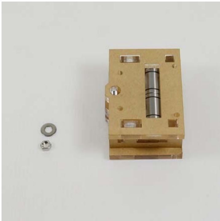
12. 準備四組 M5x40 與法蘭防鬆螺母固定，帶有軸承的 M5 螺絲則以 M5 螺母固定，以上螺絲在組裝 X 軸光軸前不要鎖太緊以免稍後還要鬆開調整。
